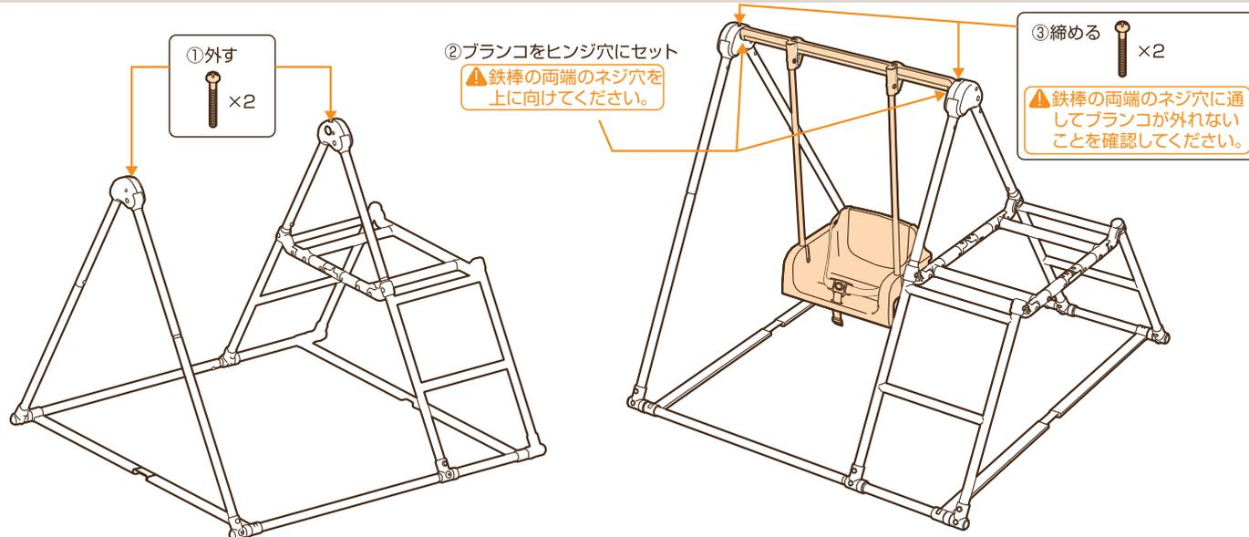
⚠ 鉄棒の両端のネジ穴を上に向けてください。
